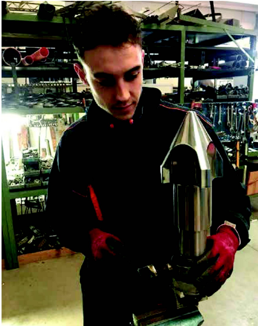
La preparazione di un pezzo da parte di un operatore. L'azienda bresciana adotta la tecnologia della cromatura a spessore, la più indicata per gli stampi per gomma.
